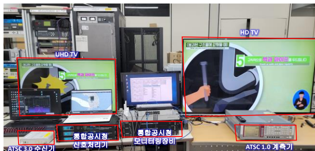
그림 3. UHD/HD 통합 공시청 실험실 테스트 환경
